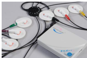
Przenośny moduł kardiografu o dwóch funkcjach: bezprzewodowa transmisja telemetryczna lub autonomiczna rejestracja typu holterowskiego
